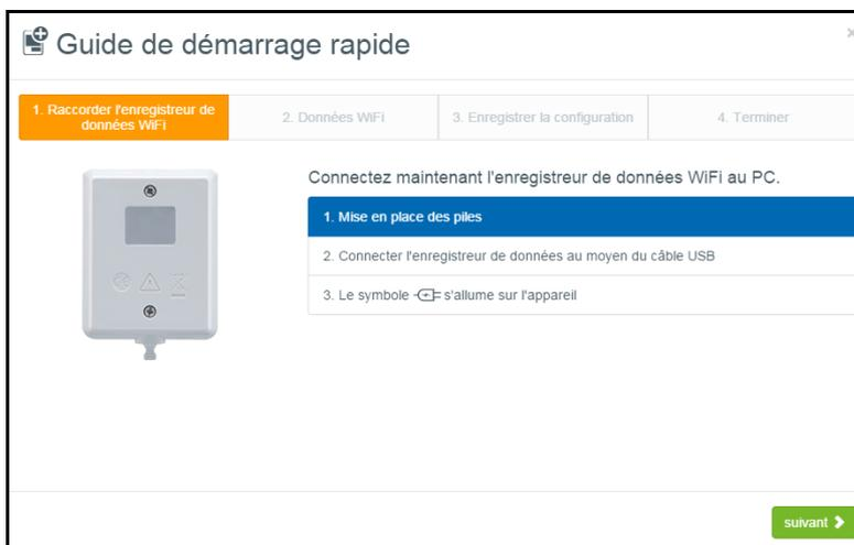
Pour ajouter des enregistreurs WiFi testo Saveris 2, il suffit de suivre une à une les étapes décrites par le « *Guide de démarrage rapide* ».
