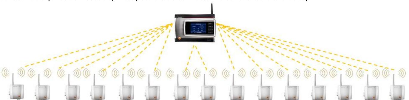
Un maximum de 5 sondes radio peut être connecté à un Routeur.
