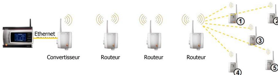
La connexion des sondes radio dans la cascade de Routeurs est flexible. Le maximum de 5 sondes radio peut être connecté n'importe où sur la chaîne de Routeurs.
