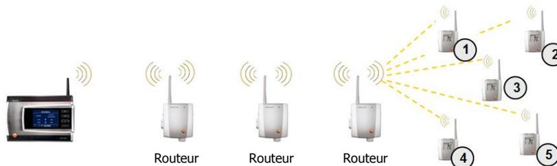
La distance radio peut être étendue via l'utilisation d'un Convertisseur au début de la cascade. Cette solution est idéale pour des bâtiments avec une infrastructure difficile et dotés d'un réseau Ethernet existant. Un maximum de 5 sondes radio par cascade de Routeurs doit toujours être respecté.
