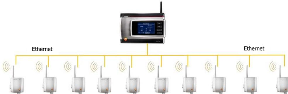
Un maximum de 15 composants radio (sondes et/ou routeurs) peut être connecté à un Convertisseur.
