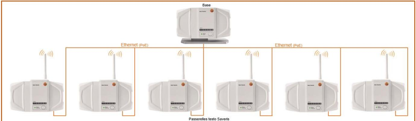
Un maximum de 40 enregistreurs testo 150 peut être connecté sur une Passerelle testo Saveris via la technologie testo UltraRange.
