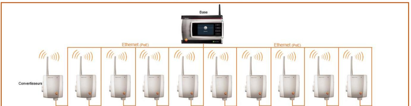
Un maximum de 15 composants radio (enregistreurs et/ou routeurs) peut être connecté à un Convertisseur.
