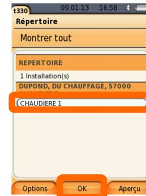
La chaudière souhaitée peut être sélectionnée, valider par « OK ». Toutes les mesures effectuées ultérieurement et devant être sauvegardées lui seront attribuées.
